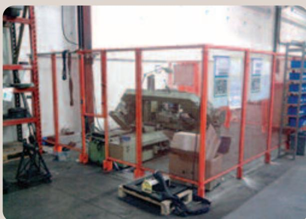
Scie automatique. Enceinte périmétrique avec un accès opérateur porte battante et un passage pièce.
