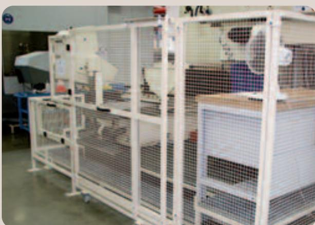
Machine automatique. Module porte coulissante avec contacteur électrique.
